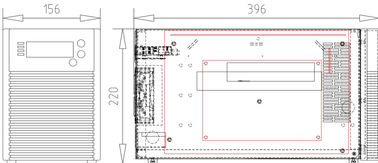
Рисунок 1.1 – Внешний вид ИБП Штиль ST1101L
