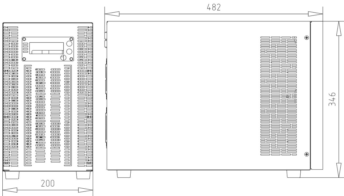
Рисунок 1.3 – Внешний вид ИБП Штиль ST1102L, ST1103L.
