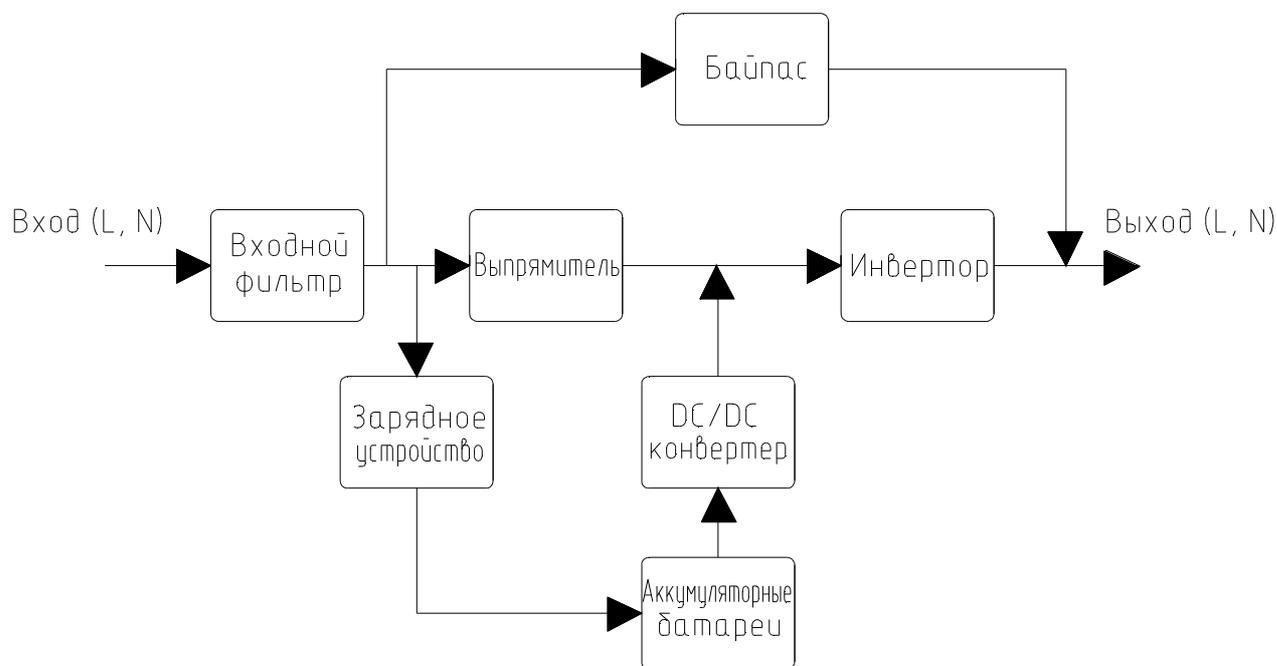
Рисунок 1.9 – Функциональная схема работы изделия
