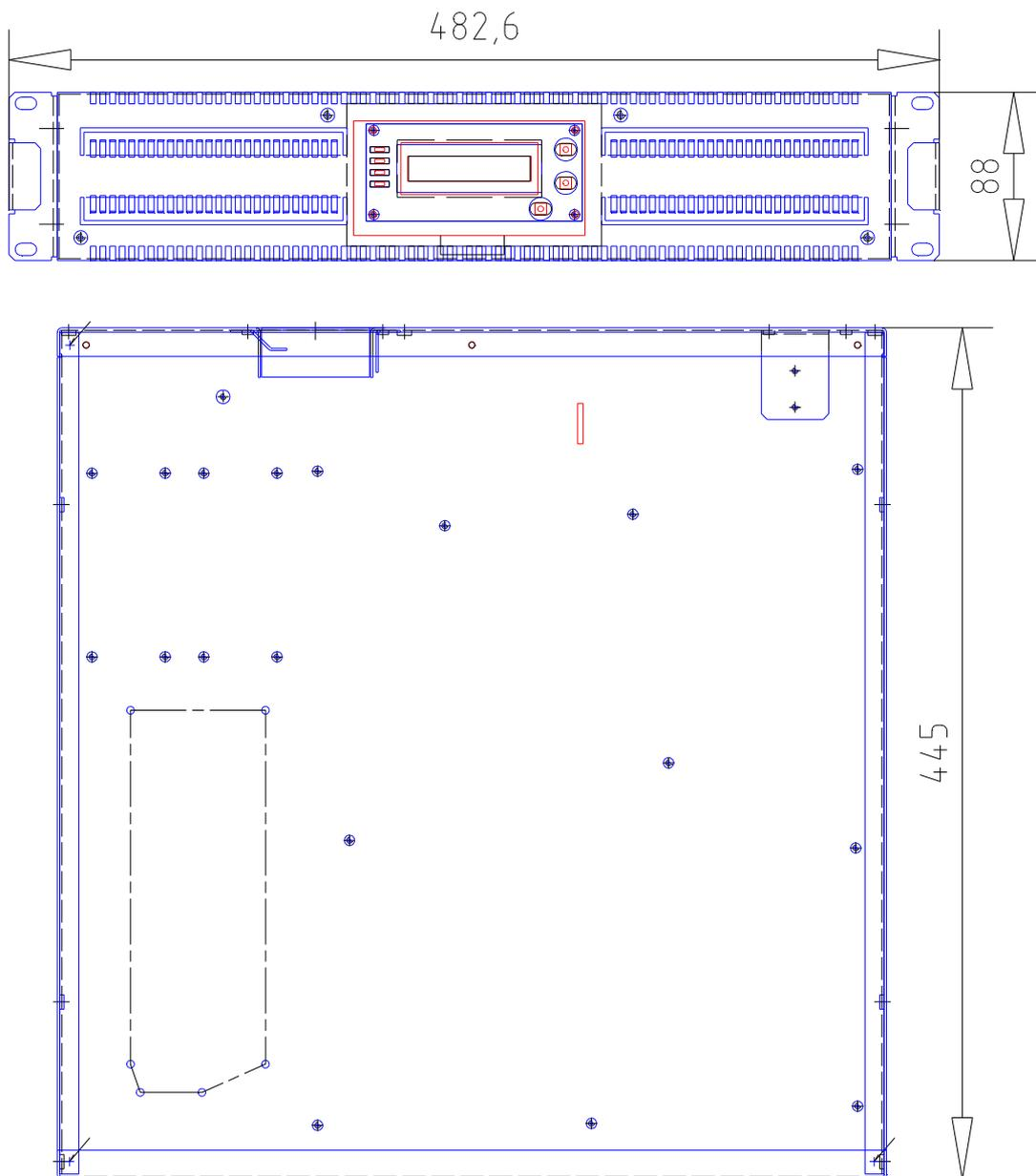
Рисунок 1.7 – Внешний вид ИБП Штиль SR1102L, SR1103L.
